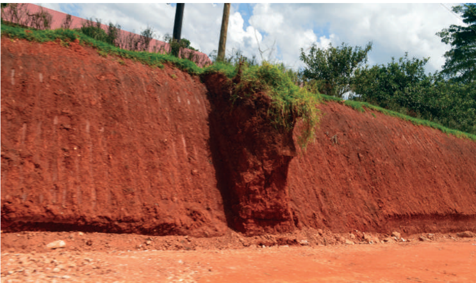
Mynd 2.9. Mikið veðruð mold í Úganda sem einkennist einkum af járn- og álsteindum ásamt breytilegu magni af kaólíníti.
